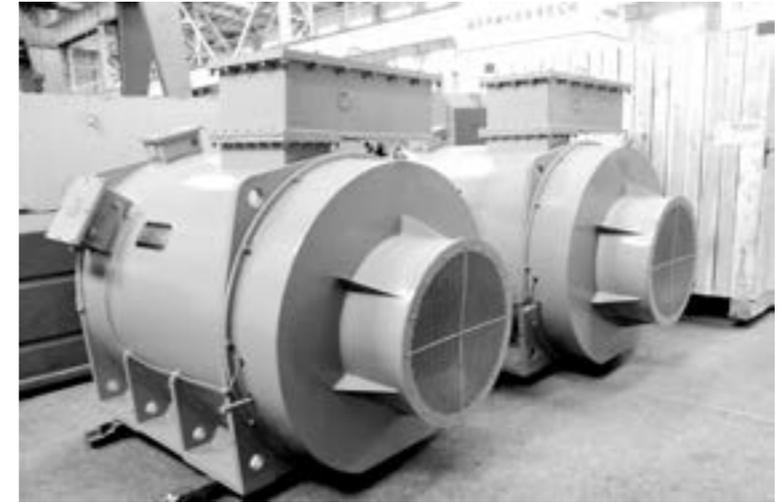
8月16日至19日，红沿河核电项目5号机组余热排出泵K1类电机（HY630-4 355kW）在佳电股份公司完成型式及出厂试验，并通过了华北核与辐射安全监督站、中广核工程公司、沈阳核电泵业有限公司现场见证，标志着我国首台余热排出泵K1类电机国产化研制成功。
