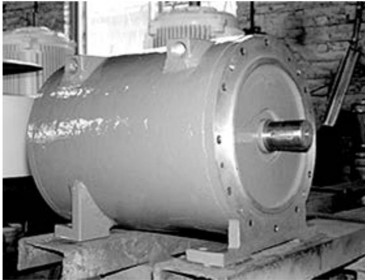
大连电机集团有限公司研发了一种纯电动车液压油泵专用电机并装车成功。在国家大力发展新能源与纯电动车的情况下，对于乘用车原有的液压泵、空调泵、水泵、气泵等，由于原有的动力源——发动机已经取消，同时纯电动车没有怠速，刹车及转向系统缺少动力，带来安全及性能方面的不安全因素。因此原由发动机驱动的这些装置就面临着如何改变驱动的问题。
